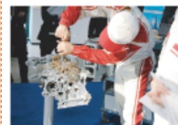
ハイブリッド車エンジンの解体
